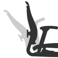
À medida que você se inclina para trás, a inclinação Harmonic™ da Celle evita que a sua região lombar fique longe do encosto, mantendo-a apoiada conforme você se move naturalmente dentro da extensão de reclinção de 28 graus da cadeira.
